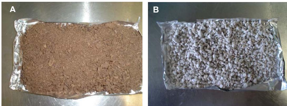
**Figura 8.** Soportes empleados en los experimentos de biofiltración. A) Turba. B) Perlita.
