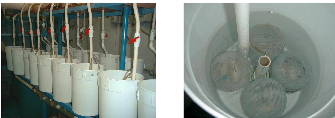
Figura 6. Sistema cerrado de recirculación de agua y cámaras utilizadas en los bioensayos.
