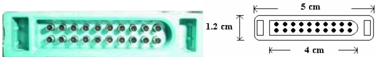
Fig. 6.2 Dimensiones del conector de 20 pines.
