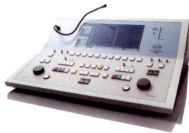
(a) Audiómetro clínico AC40 de Interacoustics A/S.
