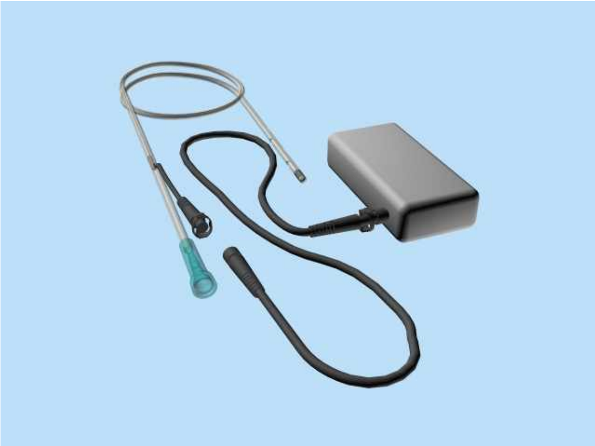
Fotografía del módulo electrónico y la sonda del espectrómetro de impedancia compleja para aplicaciones biomédicas. Reproducida con la autorización de Sacristán Rock [10].
