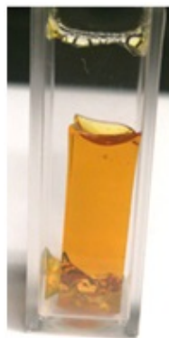
Figura 3.1.1: Apariencia del gel de óxido de zirconio de acuerdo con las relaciones presentadas en el cuadro 3.3
